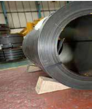
Şekil A.6.10: Silindirik malzemenin takozlarla sabitlenmesi
