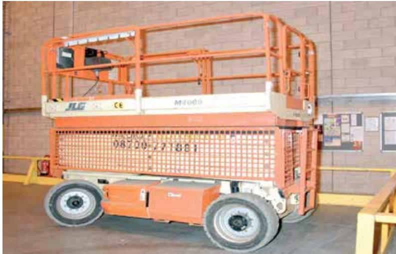
Şekil A.6.8: Yüksekte çalışma yerlerine ulaşım için kullanılan mobil - çalışma platformu kaldırma aracı
